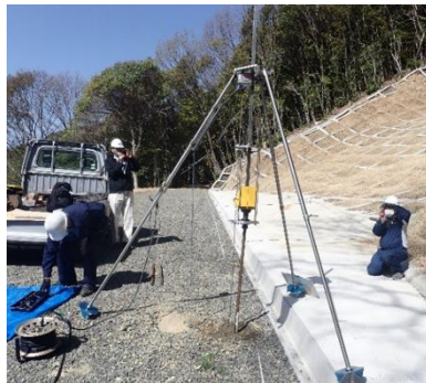
写真-1 軽重量サウンディング試験機（LWCPT）
